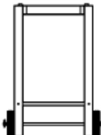
INFILARE L'ASSE DELLE RUOTE (5) INSERIRE UNA RUOTA (4), FACENDOLA PASSARE NEI FORI DELLE GAMBE (3)
