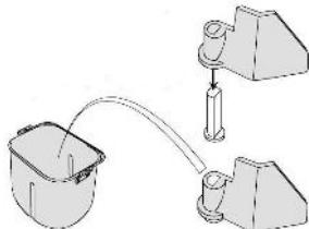
2. **Isæt æltespaden**, det er vigtigt at denne er sat ordentligt på skaftet i bunden af bagepladen. Hvis spaden ikke er isat korrekt kan ingredienserne ikke æltes og blandes korrekt.
